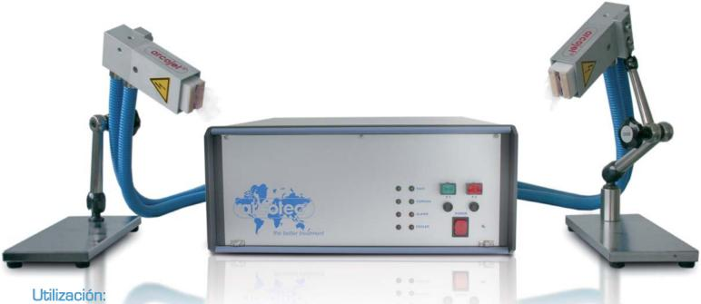
El equipo Arcojet® PG 052 se usa para el tratamiento previo de pequeñas piezas de plástico, especialmente perfiles de plástico en líneas de extrusión, piezas moldeadas por inyección, trituradoras y tubos antes de pegarlos o estamparlos. Se pueden cubrir velocidades de tratamiento hasta aprox. 15m/min (cada cabezal de electrodo). El equipo también se puede usar en la operación manual o por tacto.
